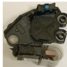
figure I-20 : Régulateur de l'alternateur A
