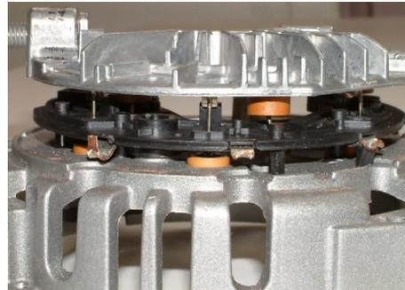
figure I-18 : Vue de côté du redresseur de l'alternateur A (pièces métalliques écartées volontairement)
