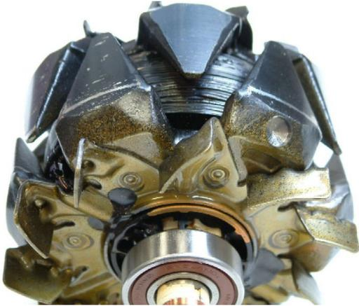
figure I-11 : Rotor de l'alternateur A
