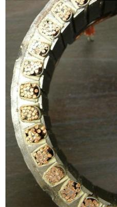
figure I-4 : Coupe du stator de l'alternateur A
