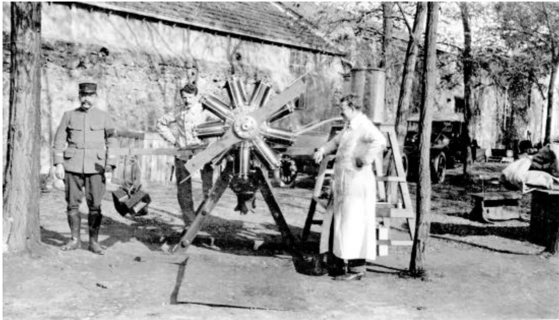
Clerget pose fièrement en habit militaire devant son moteur 9A, homologué avec succès en octobre 1914 à Chalais-Meudon à la puissance de 110 ch.
