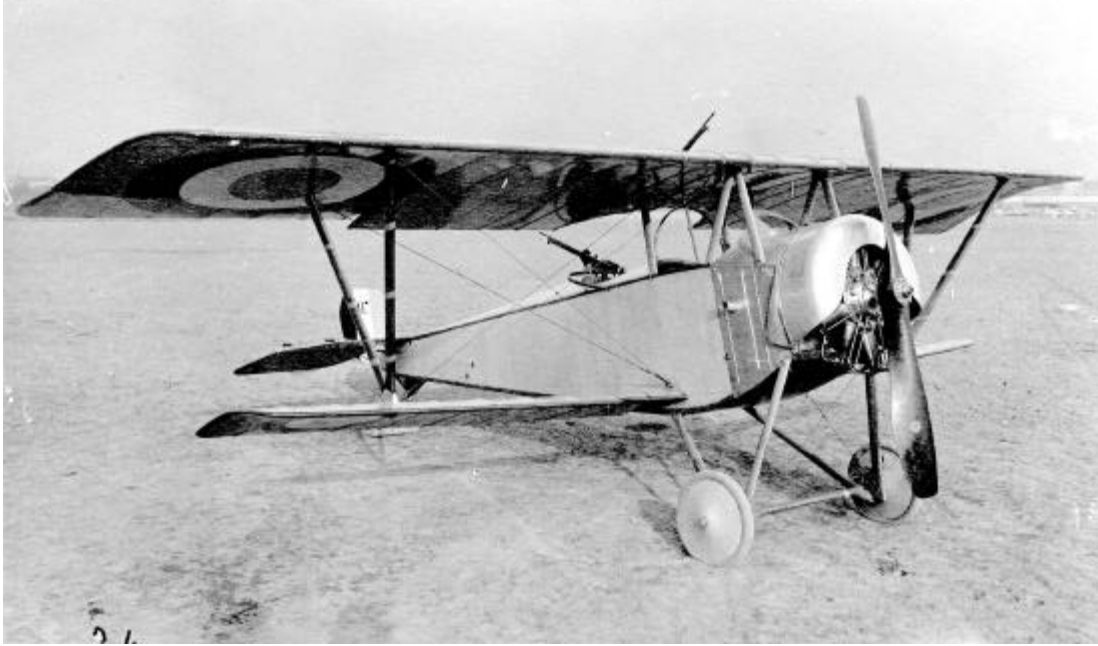
Appareil biplace d'observation et de chasse français Nieuport 12 à moteur Clerget 130 ch, en 1915. Certains appareils possédaient un plan de voilure supérieur au revêtement transparent entre les mâts, de manière à faciliter l'observation.
