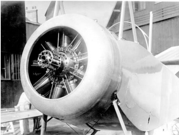
Essais d'adaptation (capotage) du moteur Clerget 130 ch dans le Nieuport 12 chez Nieuport à Issy-les-Moulineaux en 1915.
