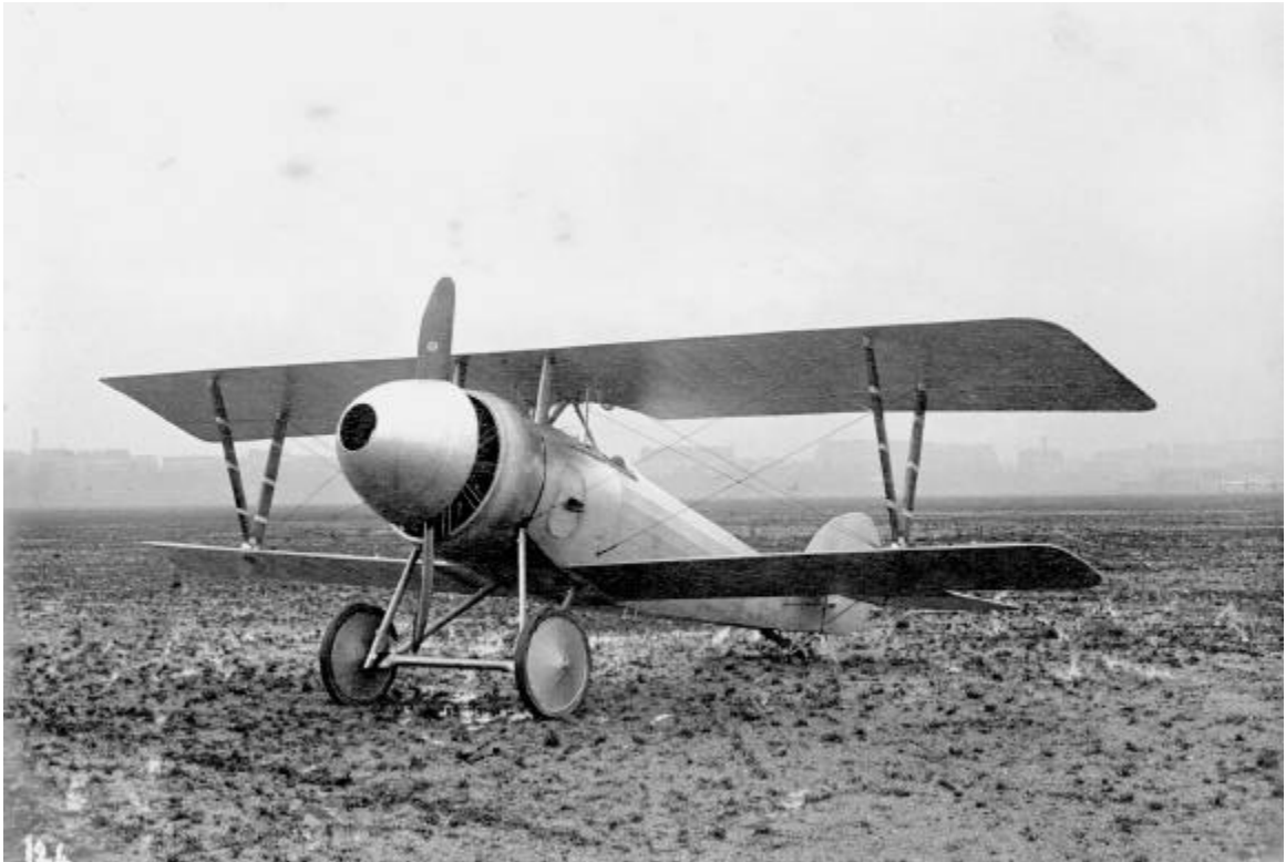
Avion Nieuport type 10 (monoplace de chasse) prototype à moteur « caréné » par une casserole fixe attachée au vilebrequin (1916).
