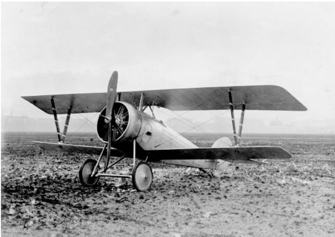
Le chasseur monoplace Nieuport type Ix (?) de Charles Nungesser à moteur Clerget 9B 130 ch équipé d'un capotage aérodynamique ultra moderne pour l'époque, en 1915. [les capotages aérodynamiques de type NACA furent inventés en 1929].
