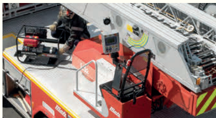
Le confort d'utilisation est assuré par les silent blocs à 45° exclusifs Honda
